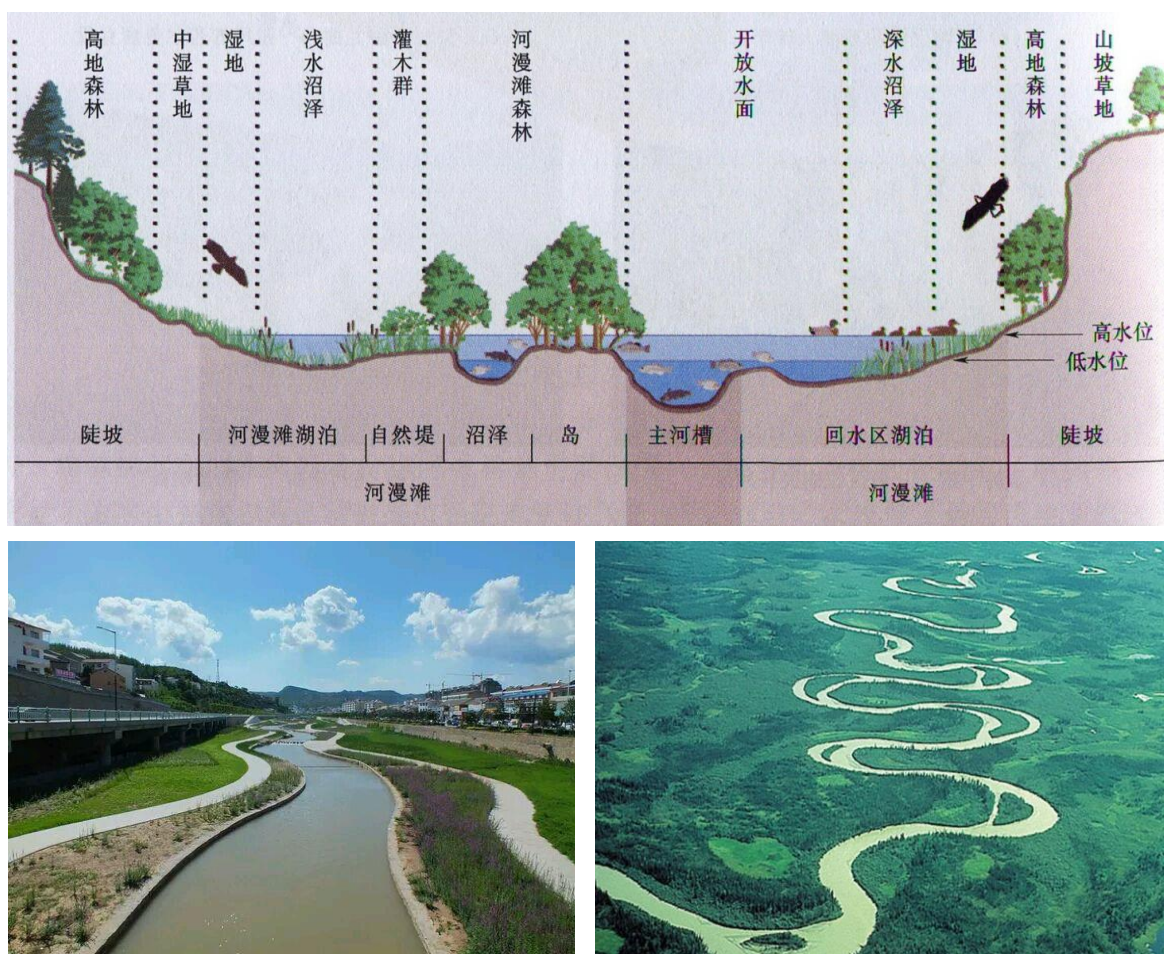
图 3-3 自然生态河道岸线布置示意图
